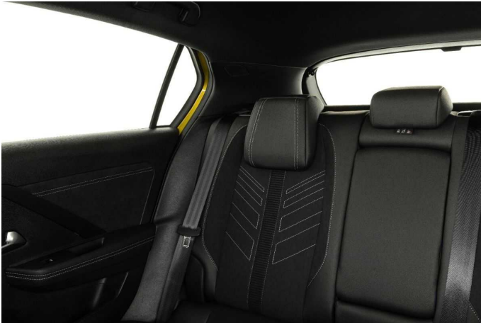
Die breiten C-Säulen schränken die Sicht stark ein. Gut gelöst: Die Kopfstützen lassen sich größtenteils versenken.
