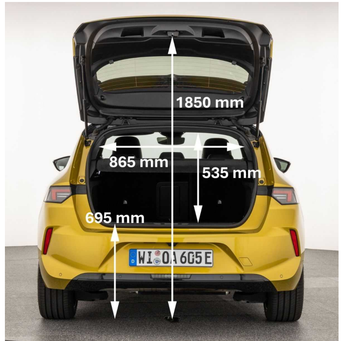
Der glattflächige Kofferraum lässt sich gut nutzen und bietet bei umgeklappten Lehnen eine nahezu ebene Ladefläche.
