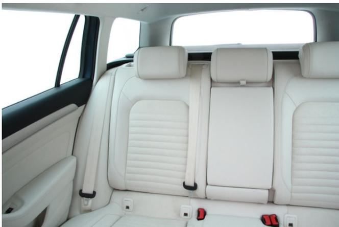
Dank der teilversenkbaren Kopfstützen im Fond ist die Sicht nach schräg hinten deutlich besser als im Vorgänger.
