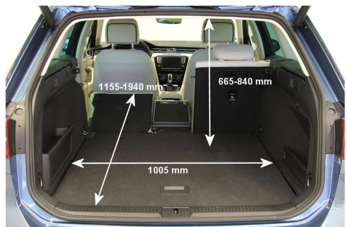
Aufgrund der verbauten Hybridkomponenten ist der Kofferraum (410 l Volumen) des Passat GTE um 65 l kleiner als beim herkömmlich angetriebenen Passat-Modellen.
