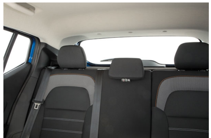
Die breiten Dachsäulen und nicht versenkbaren äußeren Kopfstützen schränken die Sicht nach schräg hinten erheblich ein.
