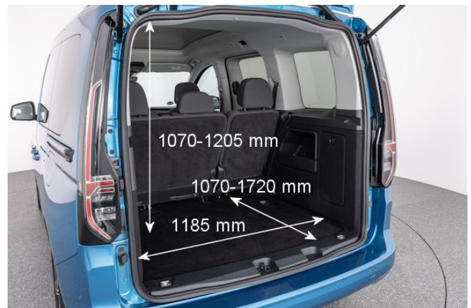
Enorme 635 l stehen für das Gepäck zur Verfügung. Das ist sogar geringfügig mehr als noch beim Vorgänger (610 l).
