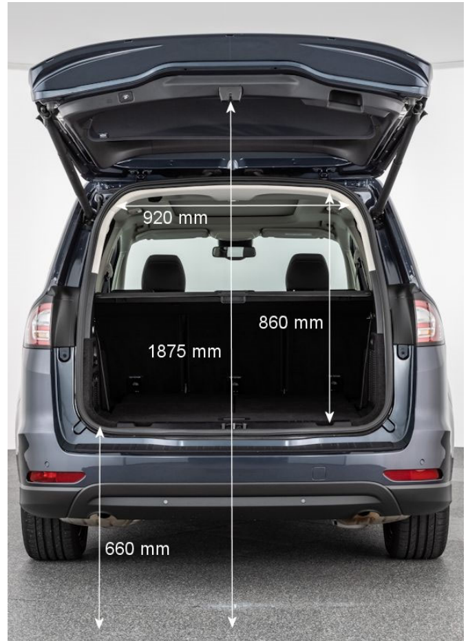
Die Ladekante liegt lediglich auf einer Höhe von 66 cm.
