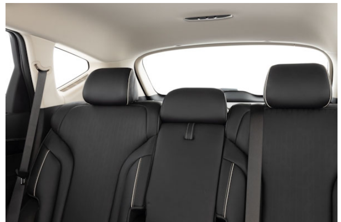
Die sehr breiten Dachsäulen und die nicht versenkbaren Kopfstützen schränken die Sicht nach hinten stark ein.
