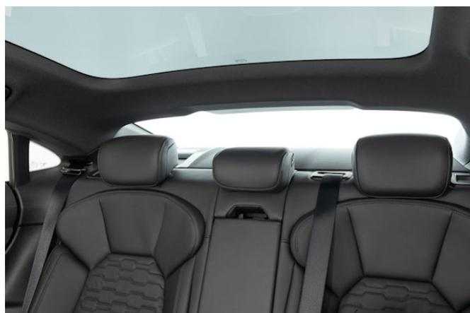
Die Sicht nach hinten wird durch breite Dachsäulen, nicht versenkbare Kopfstützen und eine hoch angesetzte, schmale Heckscheibe erheblich eingeschränkt.
