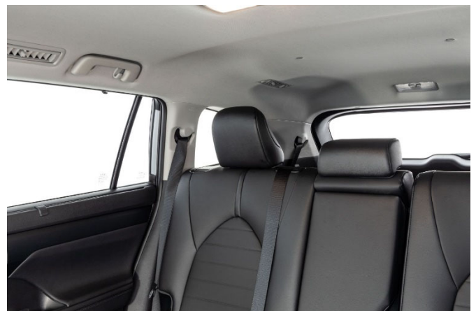
Die Sicht nach schräg hinten wird durch die breiten Dachsäulen erheblich eingeschränkt.
