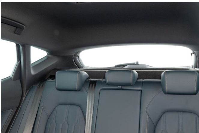
Breite Dachsäulen im Heckbereich schränken die Sicht nach schräg hinten ein.
