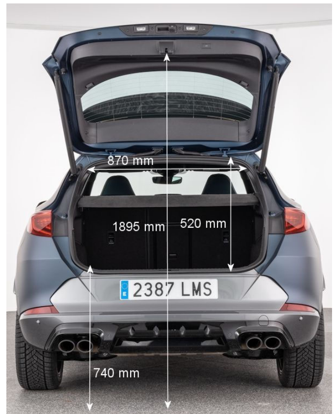
Mit einer Höhe von 74 cm macht die Ladekante das Be- und Entladen des Kofferraums zu einer recht mühevollen Angelegenheit.
