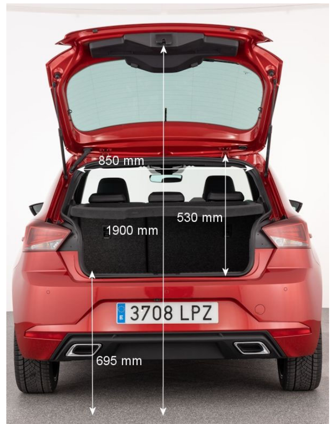
Die Ladekante mit einer Höhe von fast 70 cm macht das Be- und Entladen des Kofferraums doch recht mühsam.
