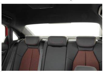
Die Sicht nach schräg hinten ist aufgrund der breiten Dachsäulen eingeschränkt. Die kleinen Dreiecksfenster bringen nur wenig Nutzen. Die Kopfstützen im Fond sind zumindest teilversenkbar und stören die Sicht nicht zusätzlich.
