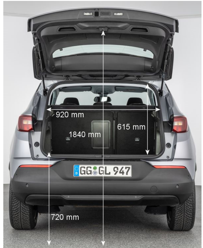
Die Ladekante mit 72 cm Höhe macht das Be- und Entladen zu einer recht mühsamen Angelegenheit.
