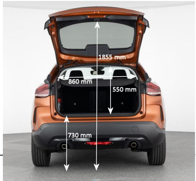
Die Ladekante mit einer Höhe von 73 cm bereitet das Be- und Entladen des Kofferraums so gut wie keine Probleme.
