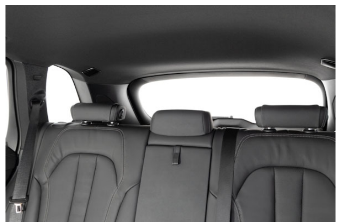
Breite Dachsäulen und nicht versenkbare Kopfstützen behindern eine akzeptable Sicht nach hinten.
