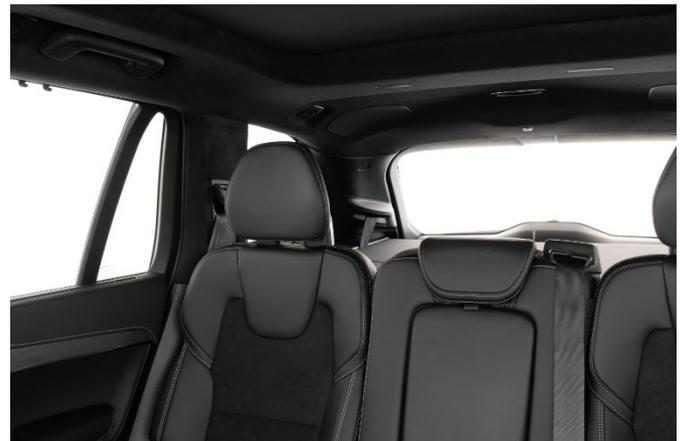
Die Fondkopfstützen sind zwar manuell klappbar, aufgestellt schränken sie die Sicht nach schräg hinten aber erheblich ein. Deshalb sollten die aufpreispflichtige, vom Fahrerplatz aus steuerbare elektrische Abklappfunktion mitbestellt werden. Eine Rückfahrkamera ist mittlerweile serienmäßig im Ausstattungsumfang enthalten.
