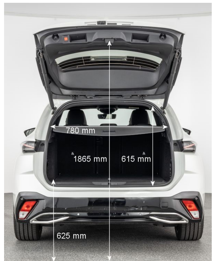
Mit etwa 63 cm liegt die Ladekante auf einem angenehm niedrigen Niveau. Das erleichtert das Be- und Entladen deutlich.
