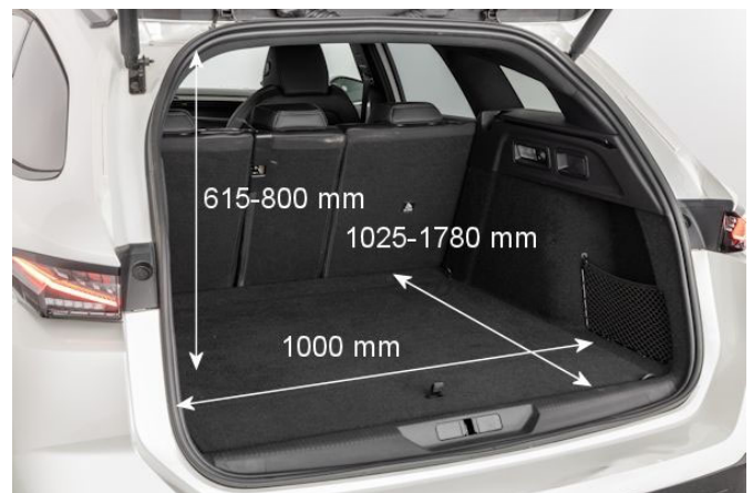
Mit 410 l Volumen ist der Kofferraum des 308 SW für eine Kombilimousine der unteren Mittelklasse angemessen.
