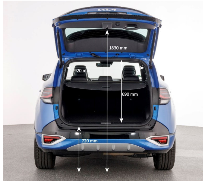
Die 72 cm hohe Ladekante macht das Be- und Entladen zu einer recht mühsamen Angelegenheit.
