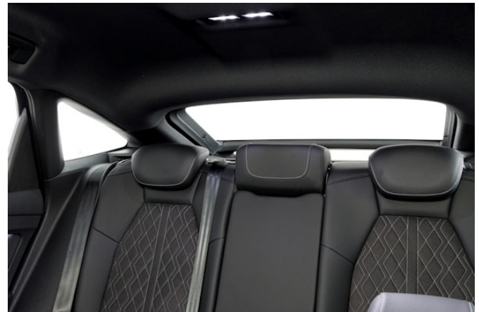
Breite Dachsäulen und die hoch ansetzende, schmale Heckscheibe schränken die Sicht nach hinten erheblich ein.
