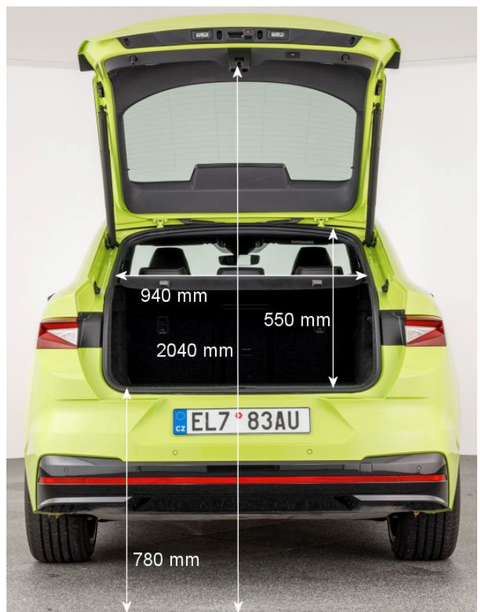
Die Heckklappe schwingt weit nach oben, so dass für Personen bis zu einer Körpergröße von ca. 1,98 m keine Gefahr besteht, sich den Kopf an dem etwas vorstehenden Schloss zu stoßen.
