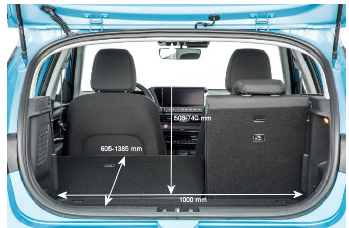
Die 48V-Batterie unter dem Ladeboden reduziert die Koffer-raumgröße auf akzeptable 205 l Volumen.
