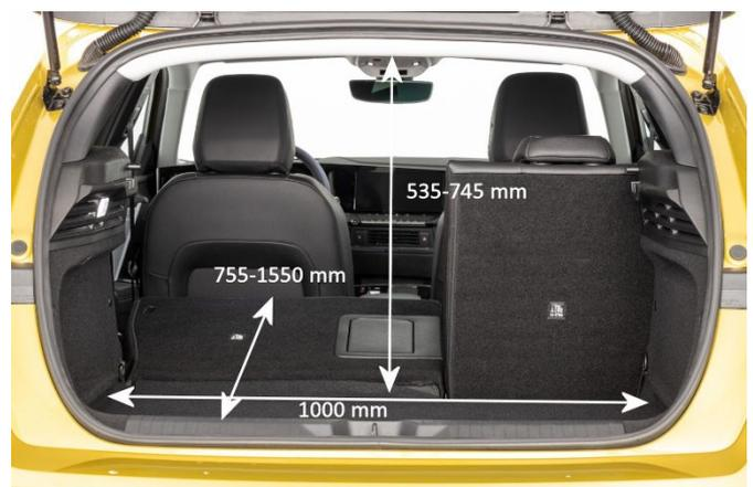
Der verbaute Akku unter dem Kofferraumboden reduziert das Kofferraumvolumen auf 260 l gegenüber den konventionell angetriebenen Modellen (305 l).
