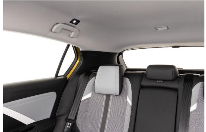
Die sehr breiten Dachsäulen und die nicht vollständig versenkbaren Kopfstützen schränken die Sicht nach hinten erheblich ein.
