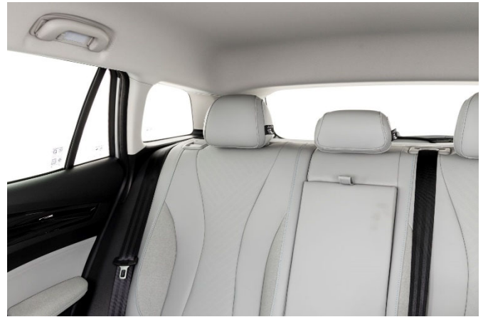
Breite Dachsäulen und nicht versenkbare Kopfstützen schränken die Sicht nach schräg hinten erheblich ein.
