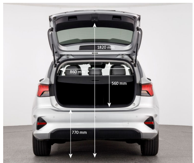
Die Ladekante mit einer Höhe von 77 cm macht das Be- und Entladen des Kofferraums doch recht mühsam.
