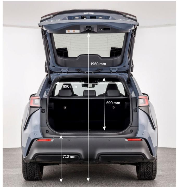
Die Ladekantenhöhe von 71 cm erleichtert das Be- und Entladen des Fahrzeugs.
