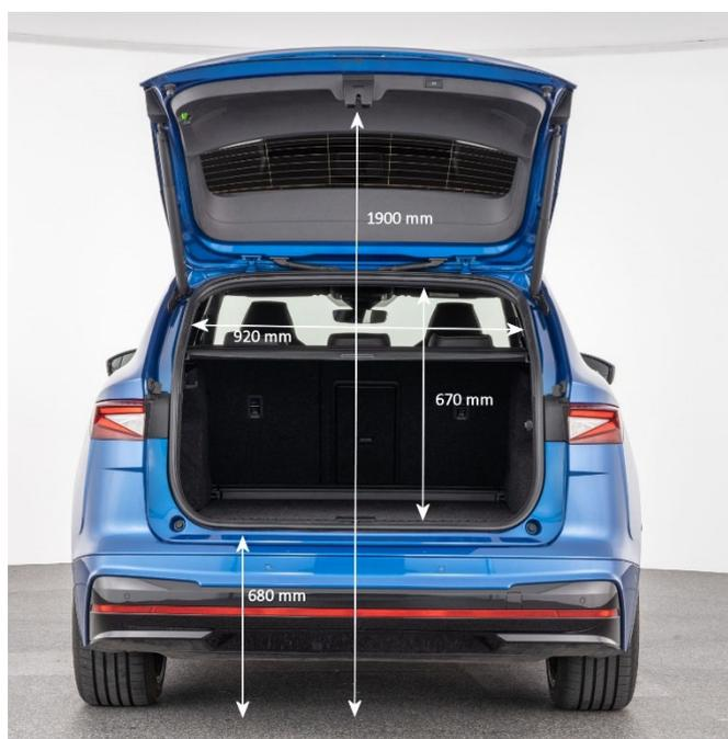
Die Heckklappe schwingt weit nach oben, so dass für Personen bis zu einer Körpergröße von 1,90 m keine Gefahr besteht, sich den Kopf an dem etwas vorstehenden Schloss zu stoßen.
