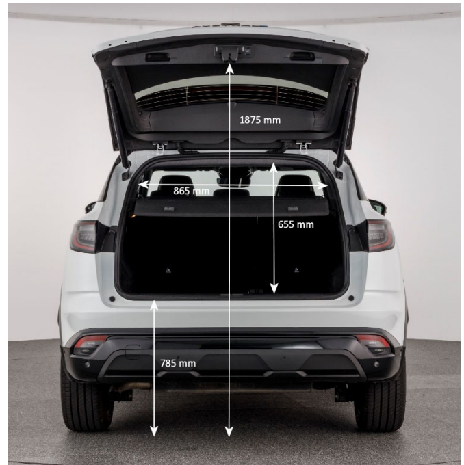
Die hohe Ladekante mit 79 cm macht das Be- und Entladen des Kofferraums zu einer mühsamen Angelegenheit.
