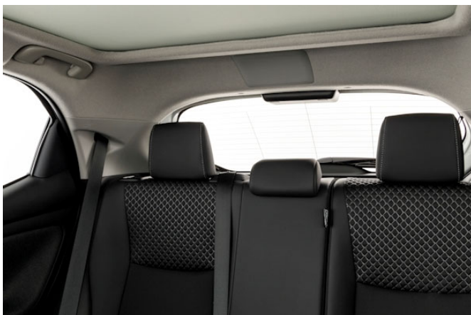
Breite Dachsäulen und nicht versenkbare Kopfstützen beeinträchtigen die Sicht nach hinten.
