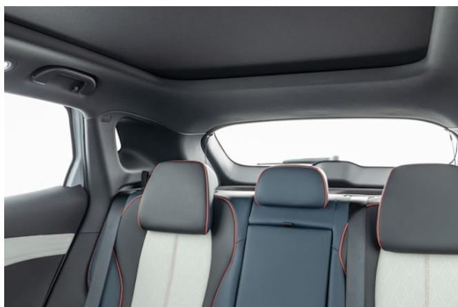
Die sehr breiten Dachsäulen und die schmale, hoch angesetzte Heckscheibe schränken die Sicht nach hinten erheblich ein.
