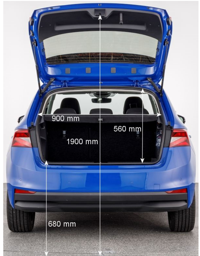
Die mit 68 cm relativ niedrige Ladekante erleichtert das Be- und Entladen.
