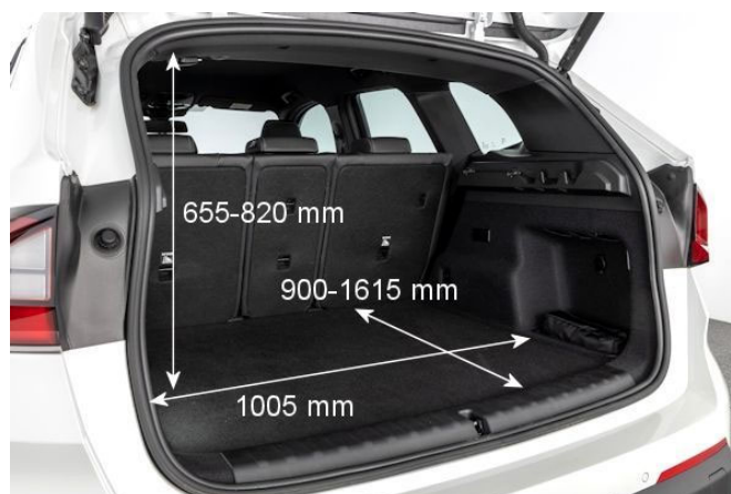
Mit 390 l Volumen bietet der Kofferraum des iX1 ordentlich Platz für das Gepäck.
