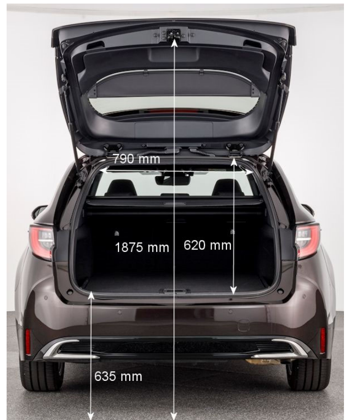
Die etwa 64 cm niedrige Ladekante macht das Be- und Entladen des Kofferraums zu einer einfachen Angelegenheit.
