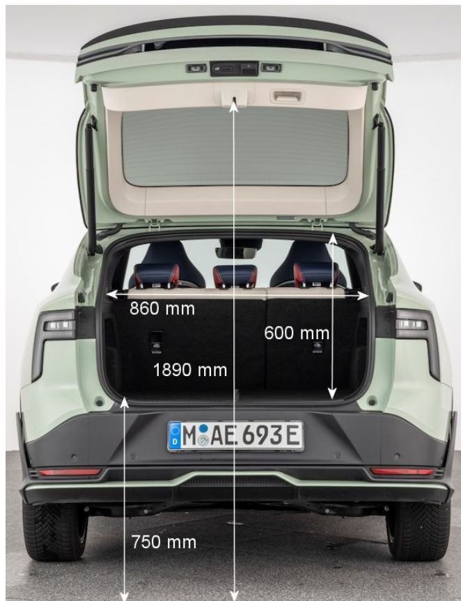
Die 75 cm hohe Ladekante macht das Be- und Entladen zu einer mühsamen Tätigkeit.
