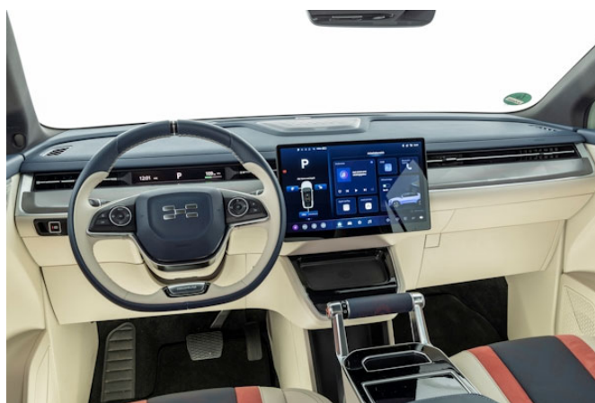
Der U6 überzeugt durch gute Verarbeitungsqualität im Innenraum und eine wertige Materialanmutung. Die Bedienung kann hier nicht mithalten. Die Konzentration sehr vieler Funktionen in das zentrale Touchscreenfeld mit schlechter Sensorik führt zu einer starken Ablenkung vom Verkehrsgeschehen.
