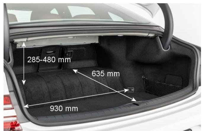
Mit 350 l Volumen ist der Kofferraum der elektrisierten Version um 30 l kleiner als beim herkömmlich angetriebenen Pendant.
