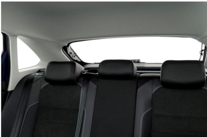
Die breiten Dachsäulen im Heckbereich und die nur teilweise versenkbaren Kopfstützen schränken die Sicht nach hinten ein.
