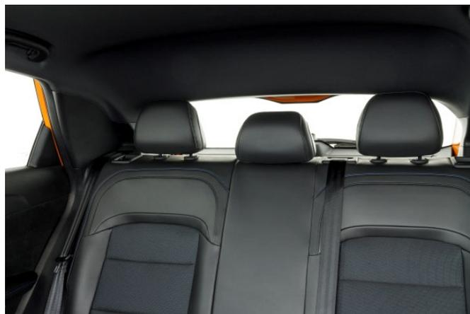
Die sehr breiten Dachsäulen und die nicht versenkbaren Fondkopfstützen schränken die Sicht nach hinten erheblich ein.
