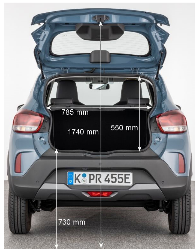
Mit 73 cm liegt die Ladekante relativ hoch und macht das Be- und Entladen recht mühsam.
