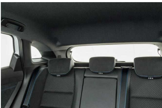
Die breiten Dachstützen und die hohe Heckscheibenunterkante verhindern eine gute Sicht nach schräg hinten.
