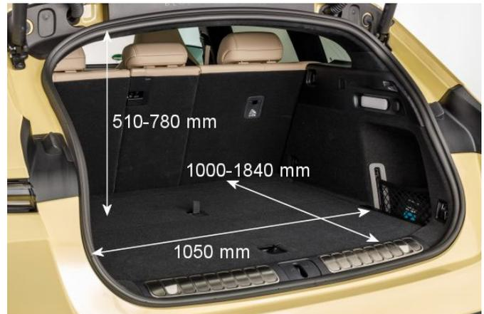
Mit 415 l Volumen ist der Kofferraum des Touring etwas kleiner als bei der Schräghecklimousine. Die Nutzbarkeit ist dagegen durch die große Heckklappe ungleich größer.
