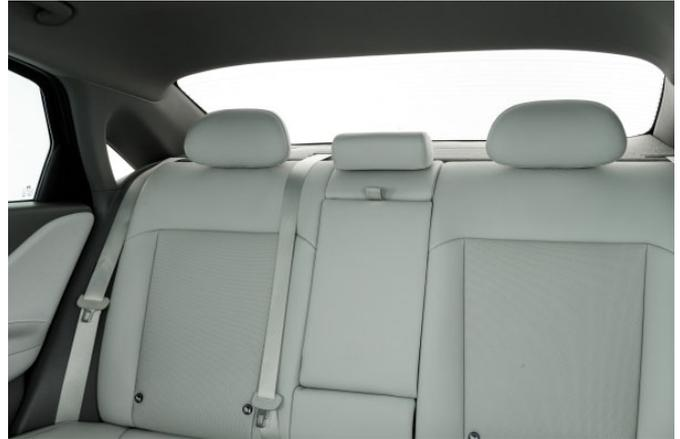
Breite Dachsäulen, nicht versenkbare Kopfstützen und die hoch angesetzte, schmale Heckscheibe schränken die Sicht nach hinten erheblich ein.
