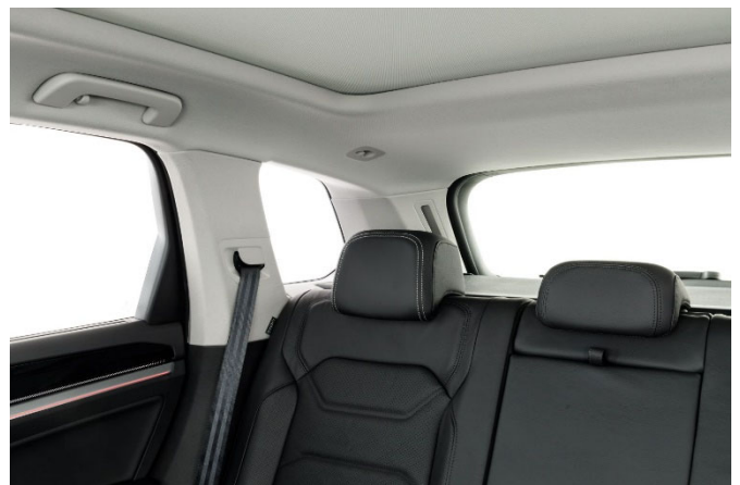
Breite Dachsäulen und nicht versenkbare Kopfstützen erschweren die Sicht nach hinten.
