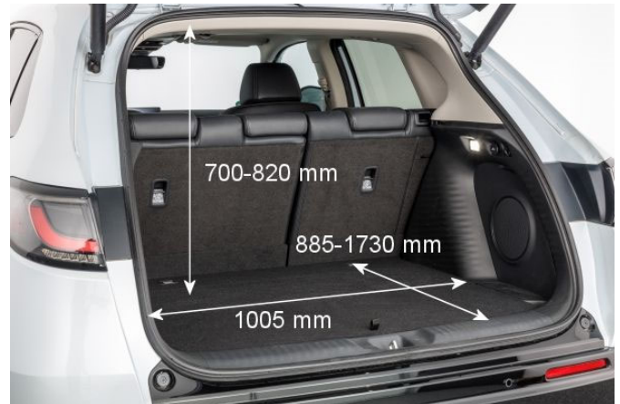
Mit 355 l Volumen ist der Kofferraum des ZR-V nicht besonders groß ausgefallen.
