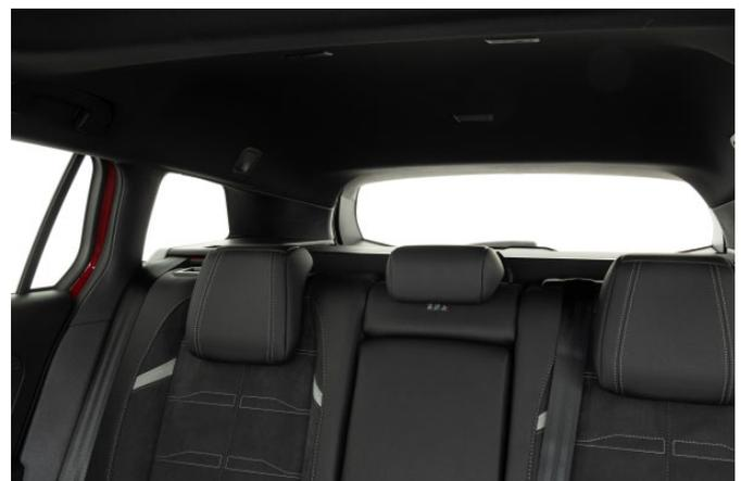
Die breiten Dachsäulen schränken die Sicht nach hinten ein. Immerhin sind die Kopfstützen fast vollständig versenkbar.
