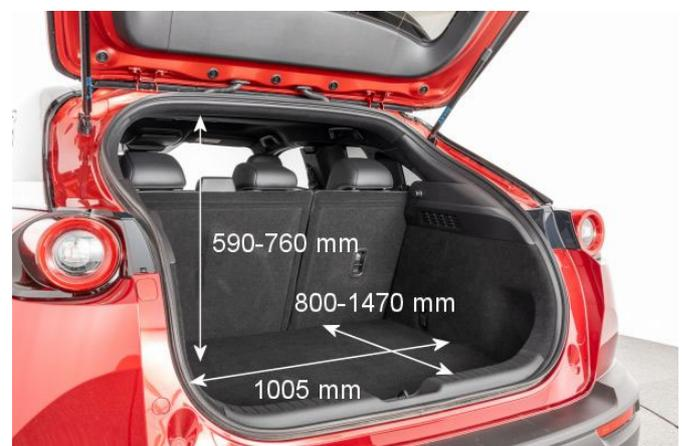
Mit 290 l Volumen ist der Kofferraum des MX-30 nur von durchschnittlicher Größe.
