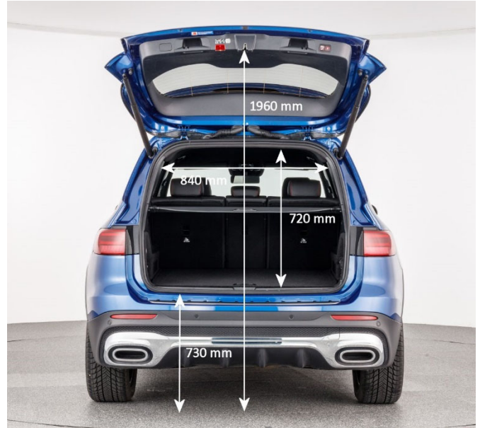
Die hohe Ladekante von ca. 73 cm macht das Be- und Entladen des Kofferraums zu einer mühsamen Angelegenheit.
