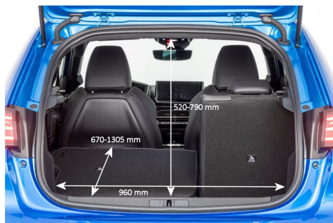
Mit 250 l Kofferraumvolumen muss man gegenüber den herkömmlich angetriebenen Varianten keine Nachteile hinnehmen.
