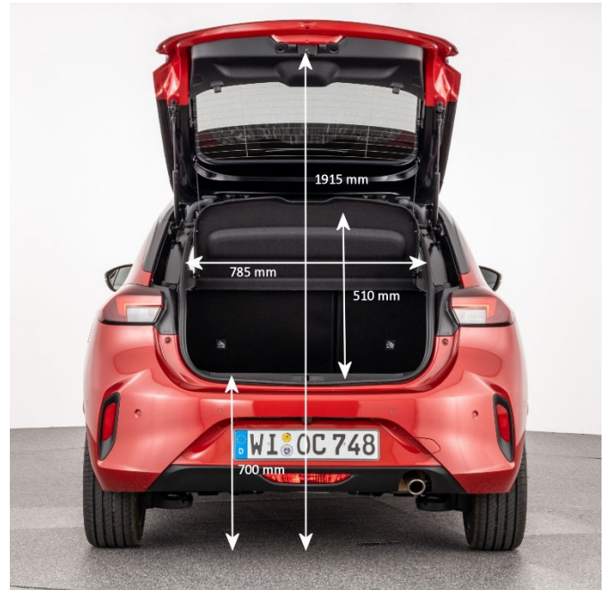
Die Ladekante liegt 70 cm über der Straße, praktikabel für's Beladen. Die 18-cm-Stufe innen stört aber beim Ausladen.
