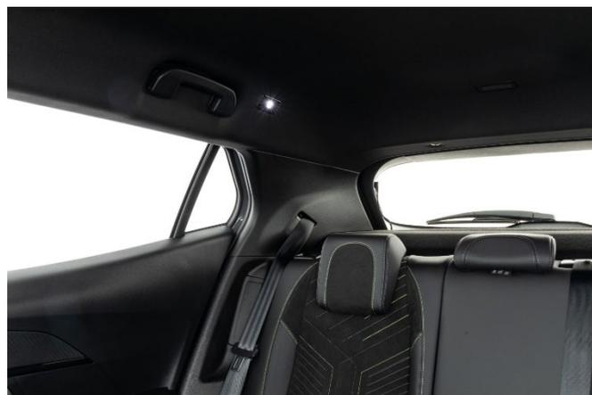
Die breiten Dachsäulen schränken die Sicht nach hinten ein. Immerhin sind die Kopfstützen im Fond fast vollständig versenkbar und behindern damit die Sicht nicht zusätzlich.
