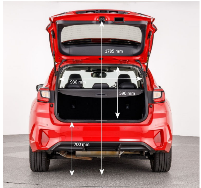
Die Ladekante befindet sich 70 cm über der Straße und damit in noch akzeptabler Höhe
