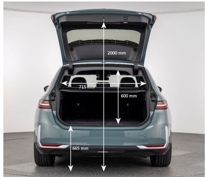
Die verhältnismäßig niedrige Ladekantenhöhe von ca. 67 cm erleichtert das Be- und Entladen des Kofferraums.
