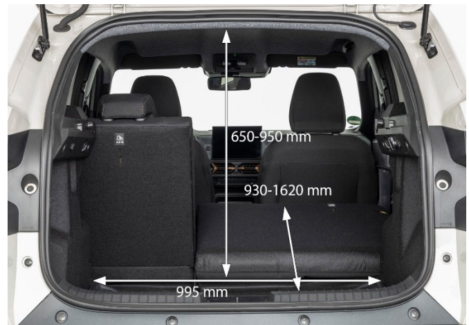
Im Normalfall fasst der Kofferraum großzügige 435 l unter der Kofferraumabdeckung. Entfernt man diese und nutzt den Stauraum bis zum Dach hoch, stehen 595 l zur Verfügung.
