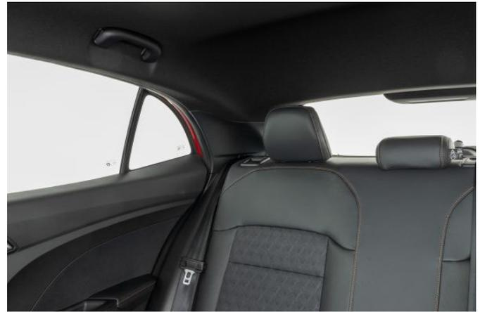
Breite Dachsäulen und nicht versenkbare Kopfstützen verhindern eine gute Sicht nach schräg hinten.
